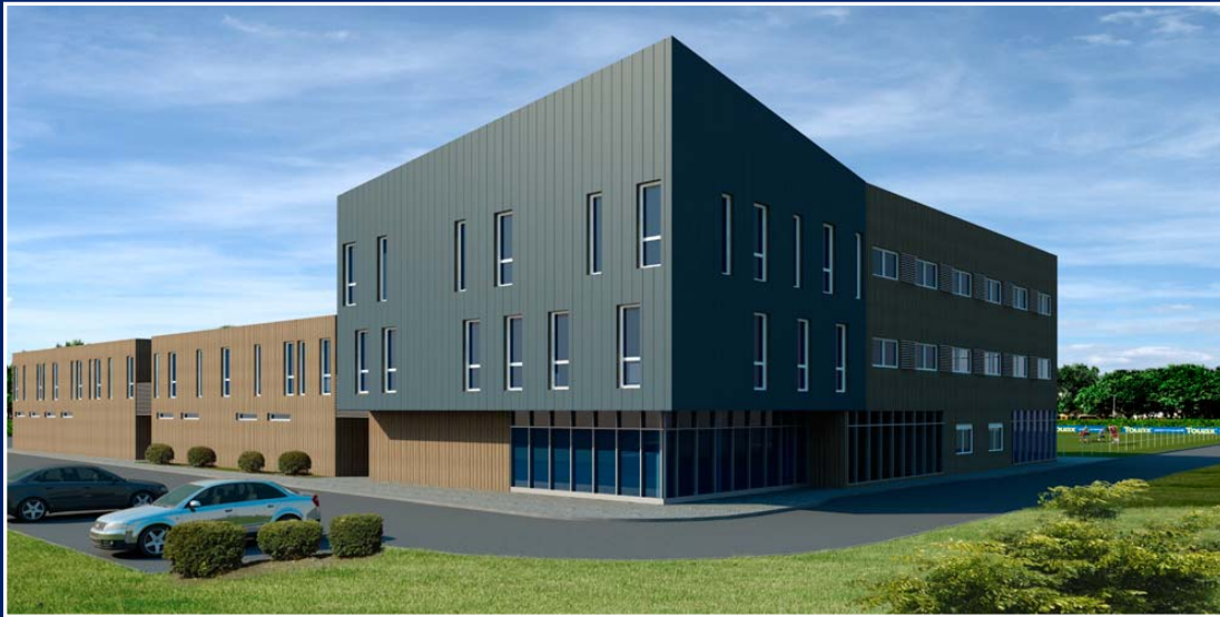
Habillage extérieur bois et acier
